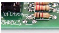
線の切れ端やメッキ線などでショートするか、「JUMPER」と記載されたハンダランドを抵抗のリードの切れ端をU字型にして接続してください。写真参照)。TTL(5V)では、各LEDは点灯しますが圧電ブザーが鳴りません。
