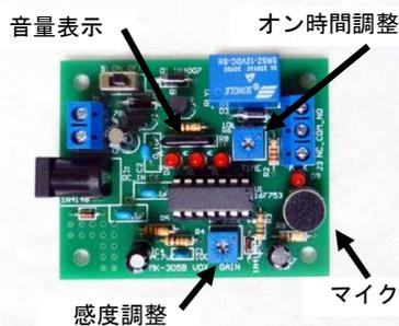
**MK-305B 用途はいろいろ。音量表示/オン時間設定/マイク/リレー付き音センサースイッチ (VOX) キット**
