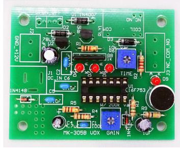
◆スライドスイッチ、ターミナルブロック（ネジ式端子）、DCジャック、リレーを実装する
