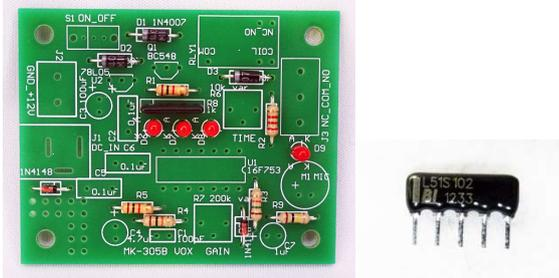
◆セラミックコンデンサー（0.1uF）を実装する
