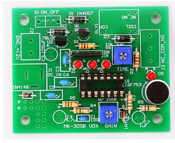
◆トランジスタ、電解コンデンサーを実装する。
