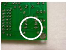
**トラブルシューティング(動かない場合):**回路が動作しない場合は、90%近くの可能性でハンダ付け不良が原因です。明るい照明の下で、ハンダ付け部分を確認してください。次にすべての部品が正しい位置に実装されているか確認してください。極性のある部品の取り付けは、その極性に注意してハンダ付けしてください(電解コンデンサー、トランジスタ、IC、ダイオード)。
