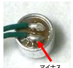
8. スピーカーに適切な電線(100cmくらいまで)を取り付け極性に注意して実装する
